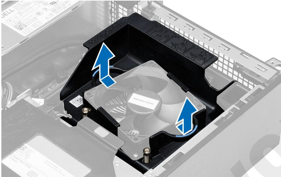
4. Desligue o cabo da ventoinha da placa de sistema. Desaperte os parafusos integrados, levante o conjunto do dissipador de calor e retire-o do computador.
