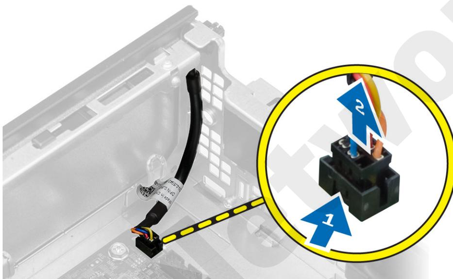
4. Carregue nos grampos em cada extremidade do interruptor de alimentação para o soltar do chassis e retire o interruptor de alimentação com o seu cabo do computador.
