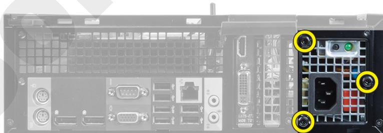
6. Carregue na patilha de desbloqueio azul e faça deslizar a fonte de alimentação em direcção à parte anterior do computador.
