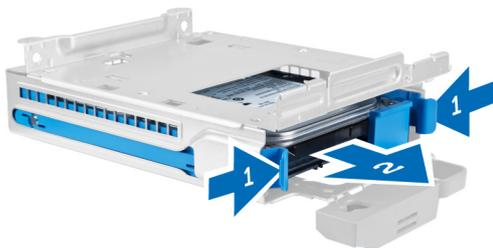
4. Flexione o suporte da unidade de disco rígido e retire a unidade de disco rígido do suporte.
