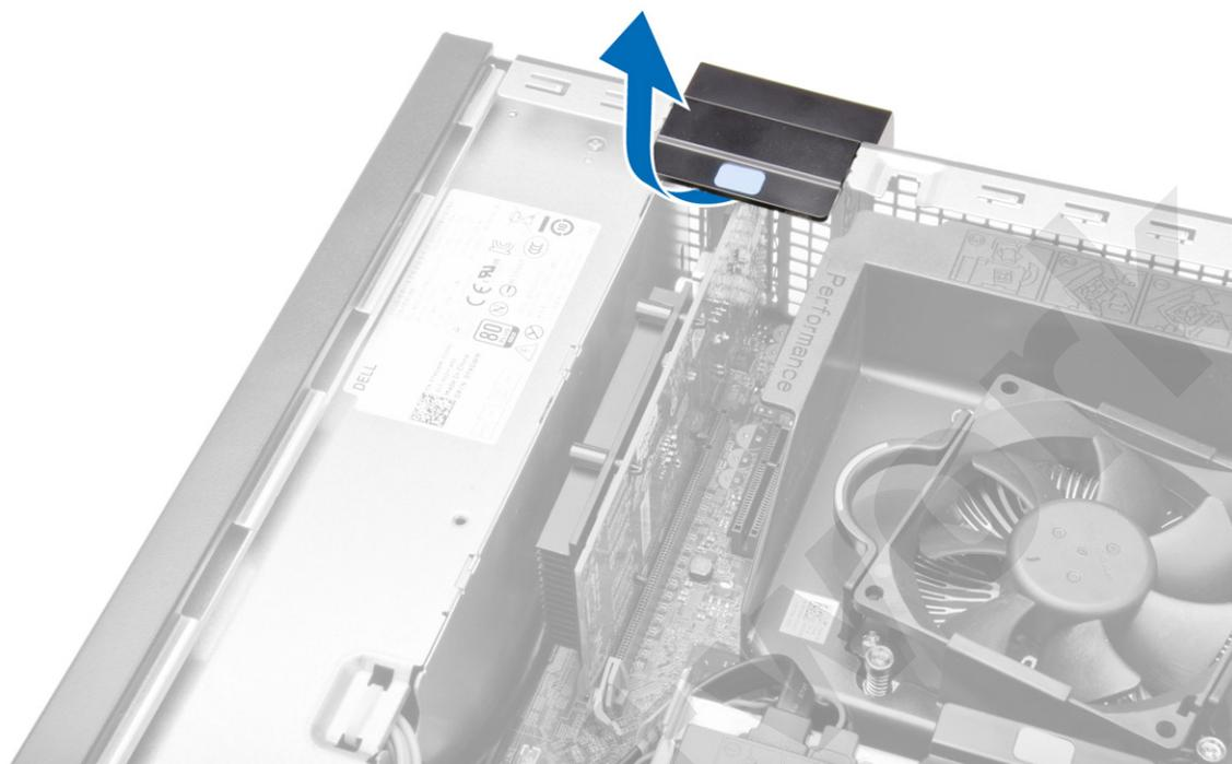
4. Afaste a alavanca de desbloqueio da placa de expansão até soltar a patilha de fixação do entalhe na placa. Em seguida, liberte a placa do respectivo conector e retire-a do computador.
