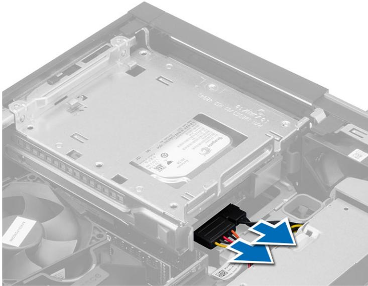
4. Faça deslizar a pega da caixa de unidades azul em direcção à posição de desbloqueio e retire a caixa da unidade de disco rígido do computador.
